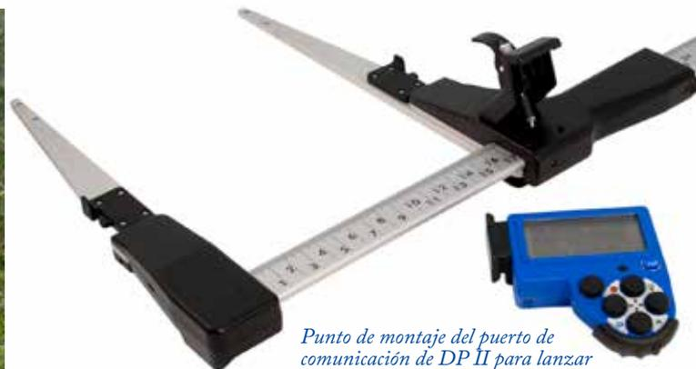
*Punto de montaje del puerto de comunicación de DP II para lanzar en el software los complementos DP.*
